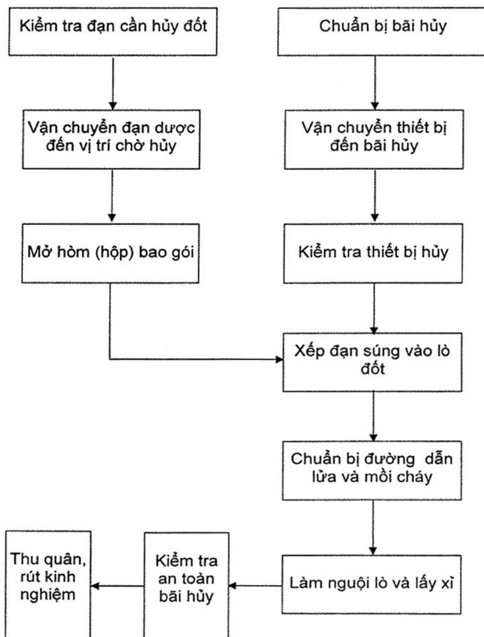
Hình A.1 - Sơ đồ quá trình công nghệ hủy đốt đạn súng bằng lò đốt đạn súng
